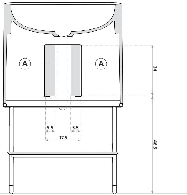
—IT (A) attacco idraulico per nuova installazione
